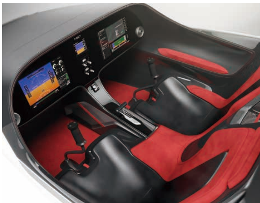
“座舱网络”高度现代化,使用平板电脑显示器
