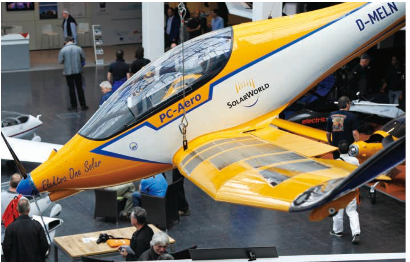
这款 Electra One 机翼覆盖太阳能电池对扩大飞行时间大有裨益
