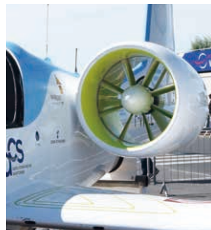
因为它采用了涵道风扇,没有外露的螺旋桨,而且它还具有双发安全性
