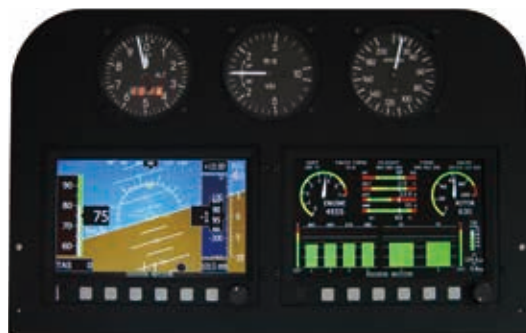
可显示发动机参数及飞行姿态，专为三角翼、旋翼机、超轻型运动飞机量身打造的 CF2000A 综合显示系统
