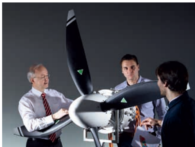
新的模拟技术和成熟的超轻型结构 确保驱动系统达到每千克5千瓦的重量性能比
