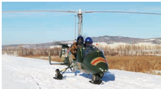
2016 年年初，安装完雪橇板的旋翼机搭载两名试飞员准备做雪地起飞
