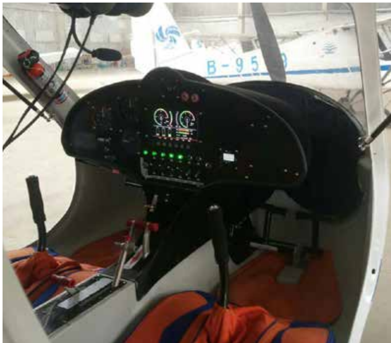
长风 CF2000B 电动飞机综合显示专款装于 RE1X 锐翔飞机
