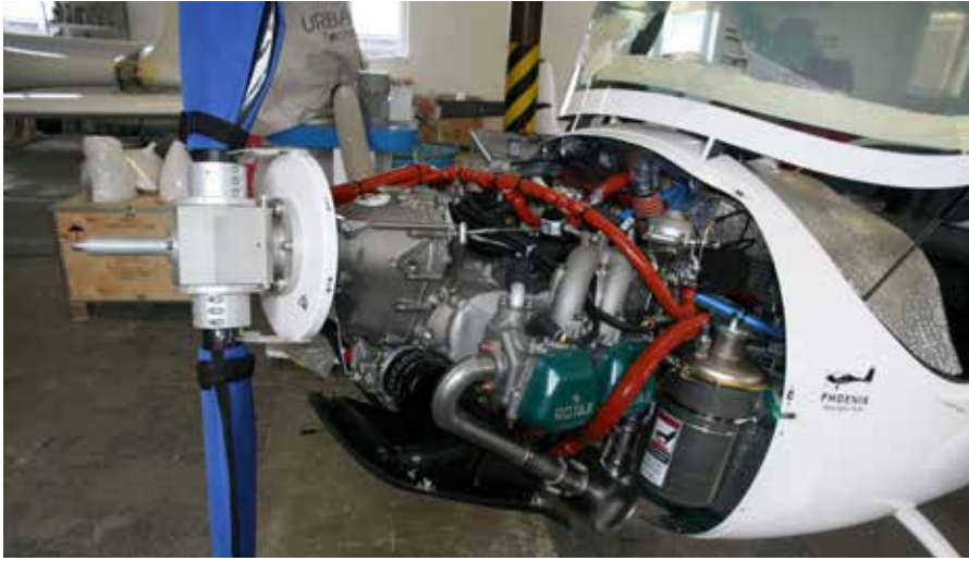
1. Phoenix 搭载的 100 马力 Rotax 912ULS 发动机
