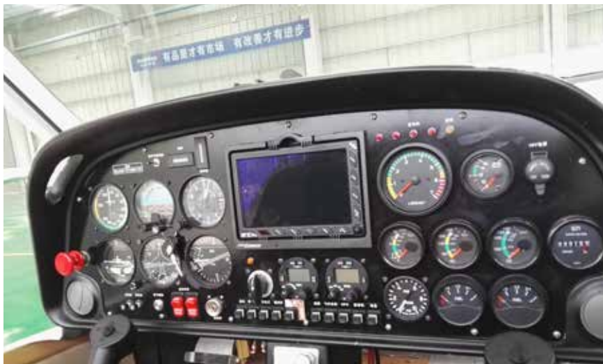
安装长风仪表的国内某轻型飞机仪表面板
