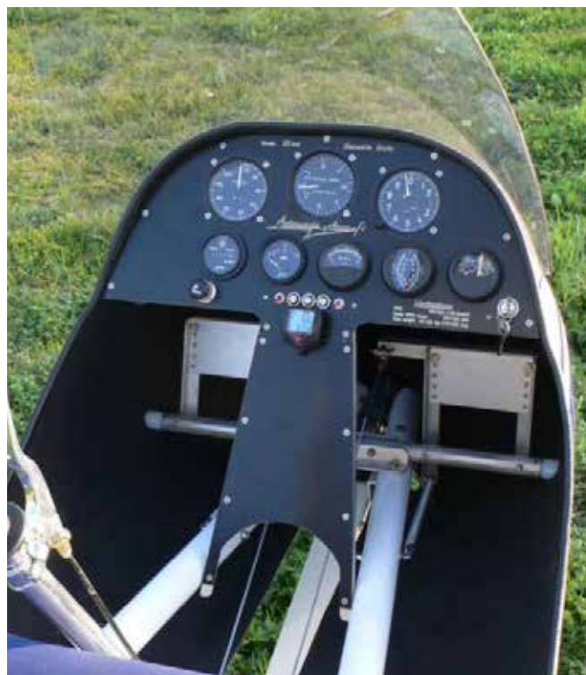
长风指针式智能飞行仪表应用于仪表板面积十分有限的三角翼上
