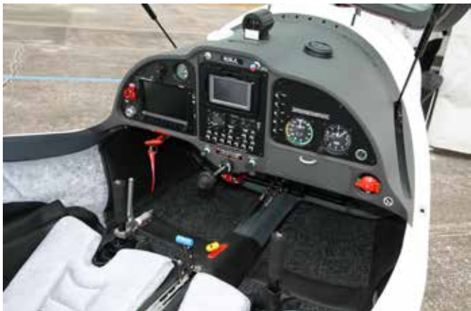
3. 驾驶舱内红色的油门控制杆吸引了我的注意，它是用于控制 Varia 螺旋桨顺桨飞行的
